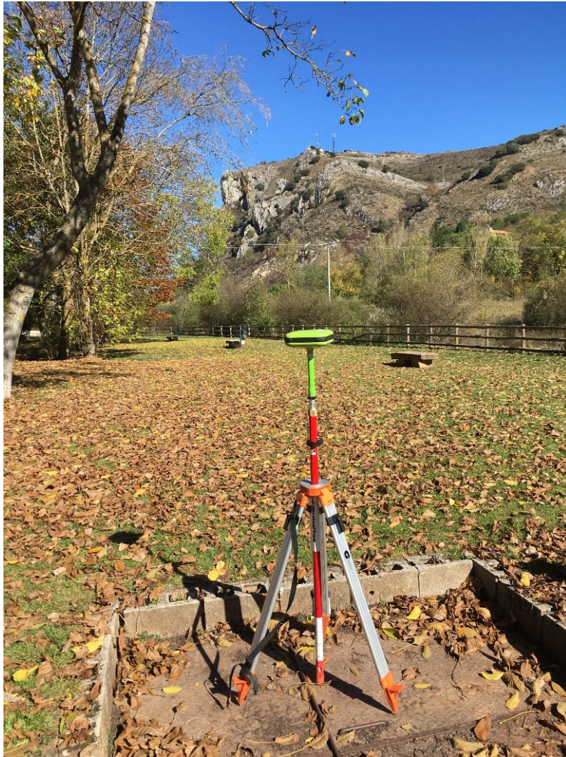
Figura 10.3 Nivelación del pozo del Parque de la margen izquierda (2111-3-0040)
