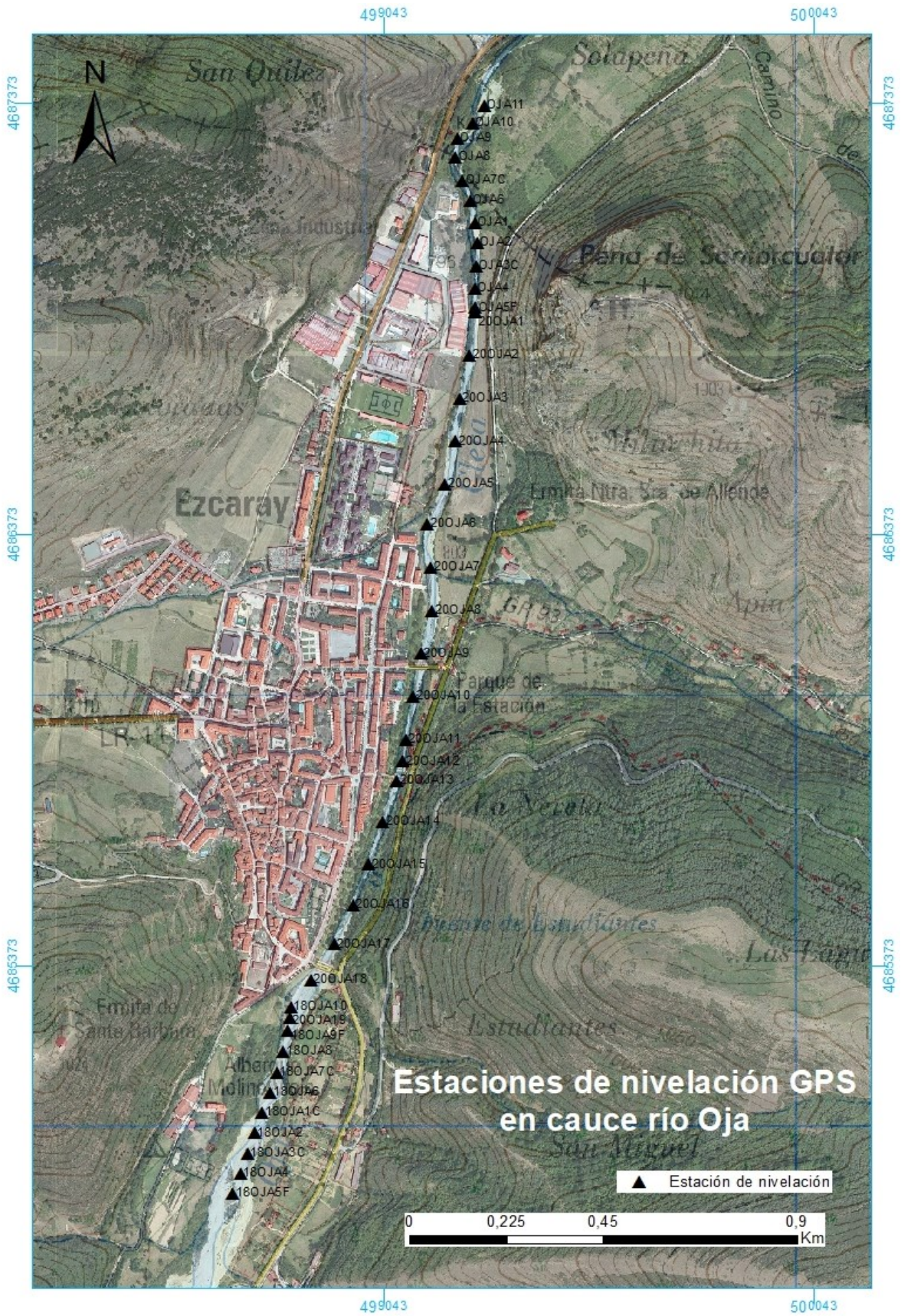
Figura 10.6. Estaciones de medida para la nivelación con GPS (octubre 2017).
