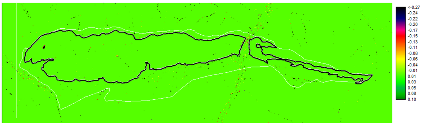
Figura 14.1.3.4-1. Mapa de zonas deprimidas (PITS). Los colores distintos del verde indican la profundidad de cada depresión respecto a su borde.
