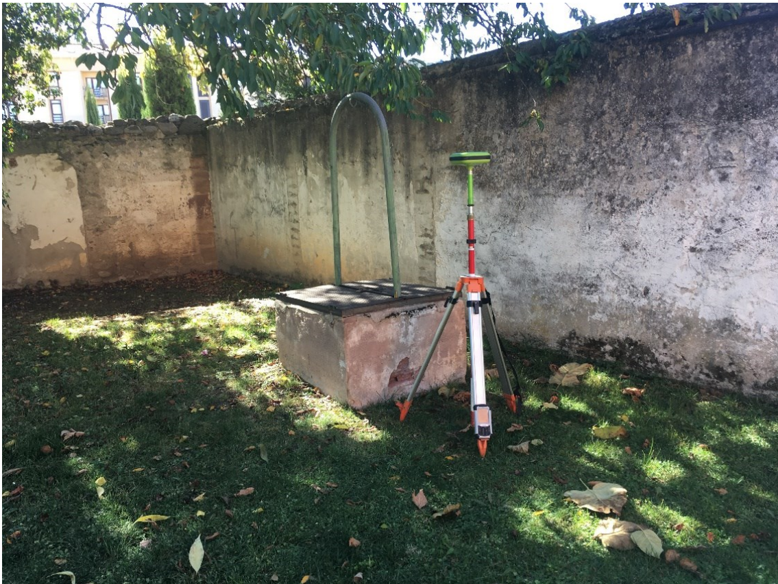
Figura. 10.2 Nivelación pozo junto al cementerio (2111-3-0037) con el receptor GPS Triump.
