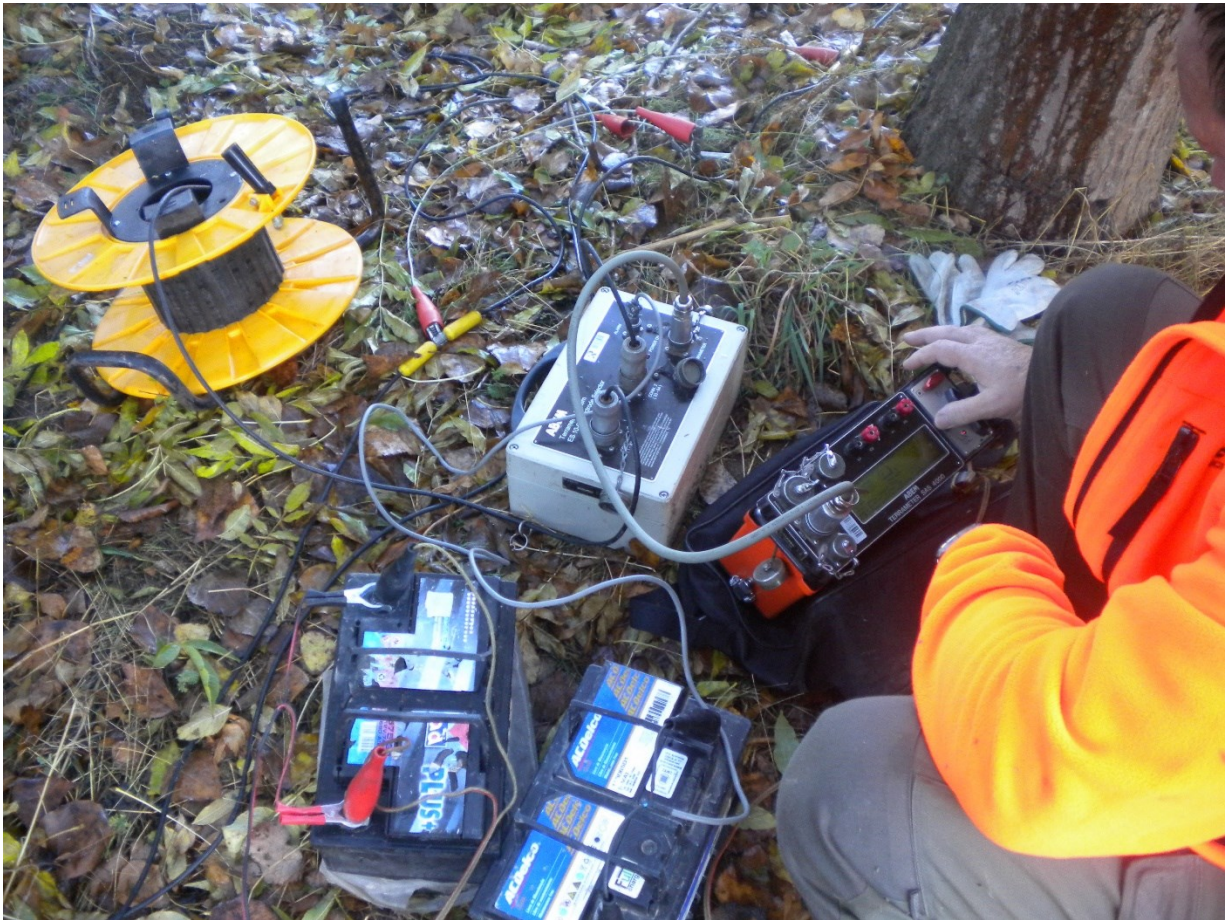
Figura 5.1.5. Imagen del equipo de resistividad empleado en la campaña
